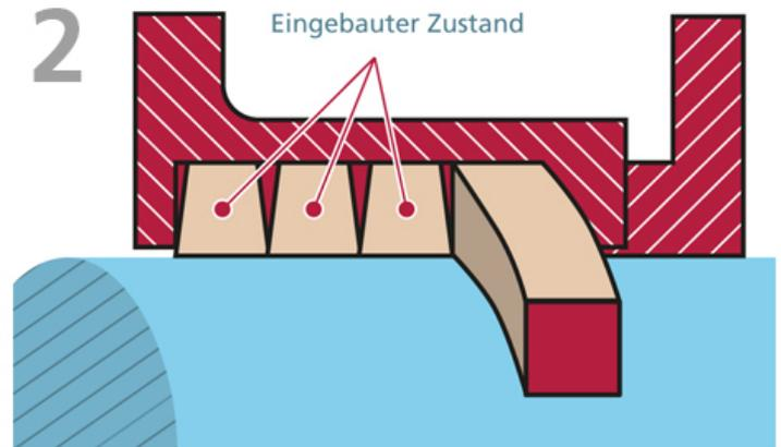
1. Die Packung füllt beim Einbau den Buchsraum aus. Das bedeutet eine gleichmäßige Druckverteilung und eine bessere Dichtwirkung.
